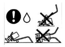
Motorhacke nicht nach vorne oder seitlich geneigt abstellen, transportieren und lagern. Gefahr dass Motorenöl in den Zylinder und Verbrennungsraum gelangt.
