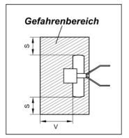
Der Aufenthalt im Gefahrenbereich der Maschine beim Starten und Betrieb ist verboten.
