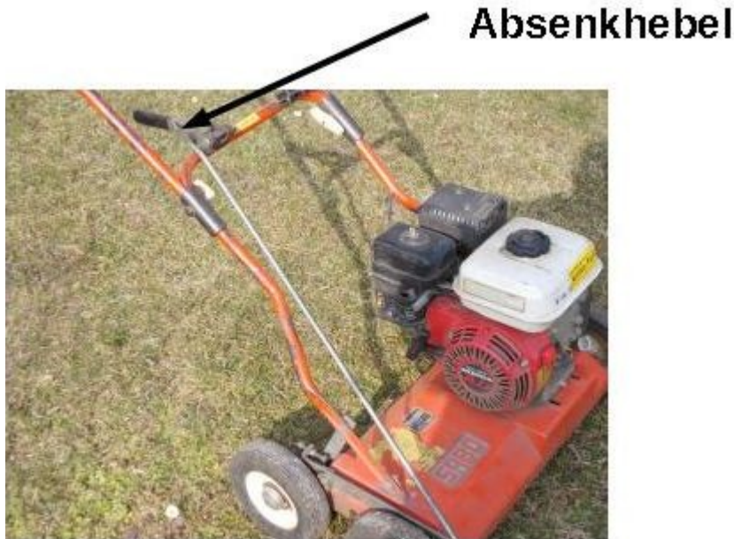
Abbildung 3: Absenkhebel für Vertikutierposition
